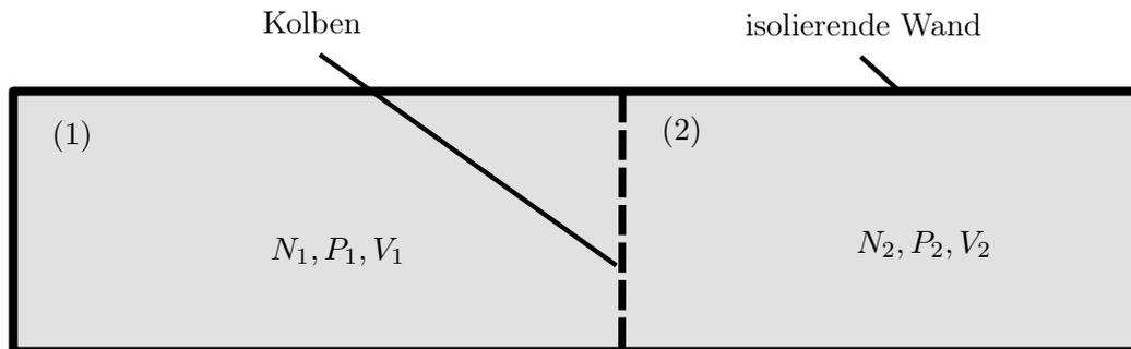
Abbildung 1: Hohlzylinder mit zwei, durch einen Kolben getrennte Kammern (zu Aufg. 1).
